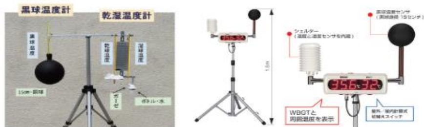
図1-18 暑さ指数(WBGT)測定装置 (左) 基本型 (右) 電子式
